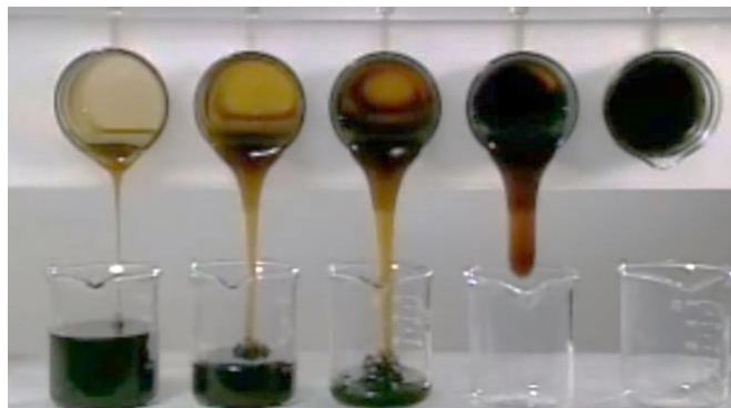
Figura 2. Escoamento de óleo de motor com diferentes viscosidades, muito utilizado em testes de qualidade deste material
