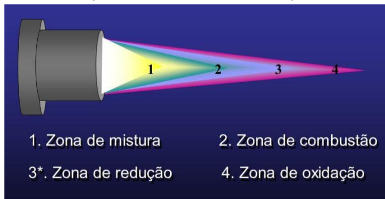
Figura 6. Zonas da chama do maçarico
