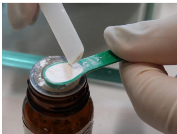
Figura 13. Remoção do excesso de pó do dosador com espátula
