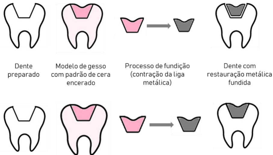
Figura 1. Representação esquemática da adaptação de uma peça metálica fundida (restauração metálica fundida) com o uso de gesso sem expansão de presa controlada (primeira linha) e gesso com expansão de presa controlada (segunda linha)
